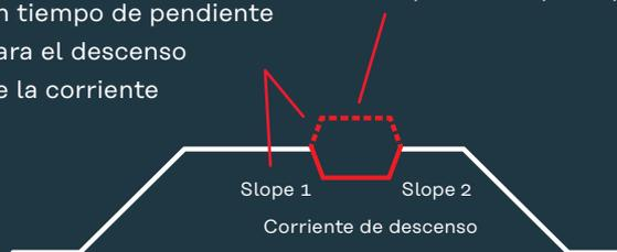
La corriente descendente sólo se utiliza para la soldadura TIG en 4 tiempos. Permite reducir o aumentar la corriente principal según se desee durante el proceso de soldadura.
