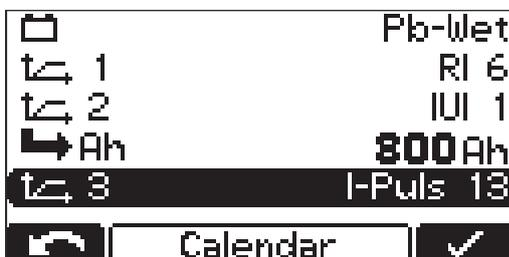
Der erste Menüpunkt „Ladeeinstellungen“ („Charging settings“) ermöglicht die Definition von 3 Kennlinien:
