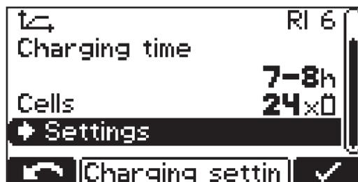
Je nach getroffener Auswahl kann die Anzeige variieren. Wenn wie in der Abbildung als Batterietyp „Pb-WET“ gewählt wurde - in Verbindung mit der Kennlinie („Curve“) „RI“ - wird die Rubrik „Ah“ durch eine Einstellmöglichkeit der „Ladezeitspanne“ („Charging time“) ersetzt.
