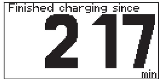
Das Batterie-Symbol dient als Anzeige des momentanen Ladezustandes. Je mehr Balken dargestellt werden, desto weiter ist der Ladevorgang fortgeschritten. Sobald die Batterie vollständig geladen ist, erscheint ein Minutenzähler (Abbildung rechts). Dieser zählt die Minuten seit dem Ladeende und dient als Hilfestellung, um beim Einsatz mehrerer Ladegeräte leichter beurteilen zu können, welche Batterie bereits am weitesten abgekühlt ist.
